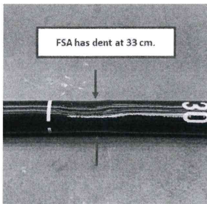
รูปที่ 1 ภาพแสดงอาการสายยางดำหุ้มท่อส่วนเข้าสู่ตัวคนไข้มียรอยกดทับที่ระยะ 33 เซนติเมตร (FSA has dent at 33 cm.)
