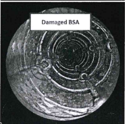
รูปที่ 4 ภาพแสดงอาการชุดสลึงส่วนควบคุมทิศทางของกล้องได้รับความเสียหาย (Damaged BSA)
