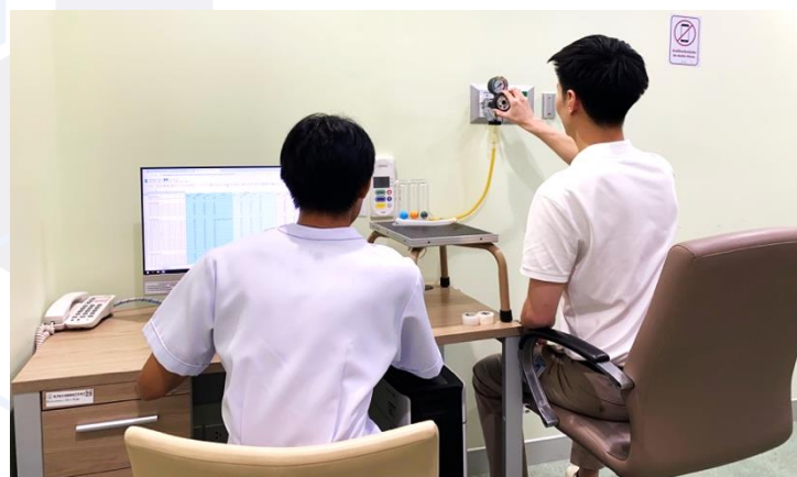
รูปที่ 5 การเก็บข้อมูลความดันลบที่น้อยที่สุดจากอุปกรณ์ FIS (ที่มา: ปฏิพล ก้าวงามพาณิชย์ และ กรวิชญ์ ลิขิต)
